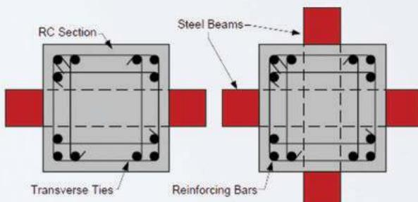
شکل ۵-۲: نحوه قرارگیری آرماتورهای طولی در ستون بتنی
