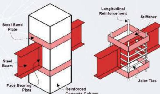
شکل ۵-۱: اتصال بین تیر فولادی و ستون بتنی
