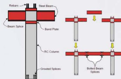
شکل ۴-۲: اجرای قاب RCS با استفاده از روش پیش‌ساخته
