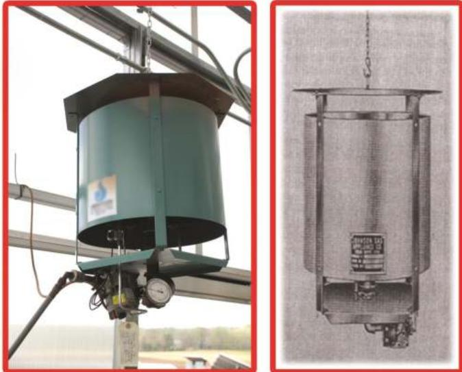
در شکل بالا، نوعی از ژنراتورهای مولد دی اکسید کربن را می‌بینیم که امروزه معمول و متداول است و دارای قدرت اندازه‌گیری فشار گاز و بیوینی ۲۴ ولت است. این دستگاه توان تهیه و تولید ۱۵۰۰ ppm گاز دی اکسید کربن را در گلخانه‌ای معمولی به مساحت ۴۶۵ متر مربع دارد. سوخت آن نیز مواد نفتی مایع یا گاز است و میزان حرارت تولیدی آن ۱۵۱۲۰ کیلوکالری
